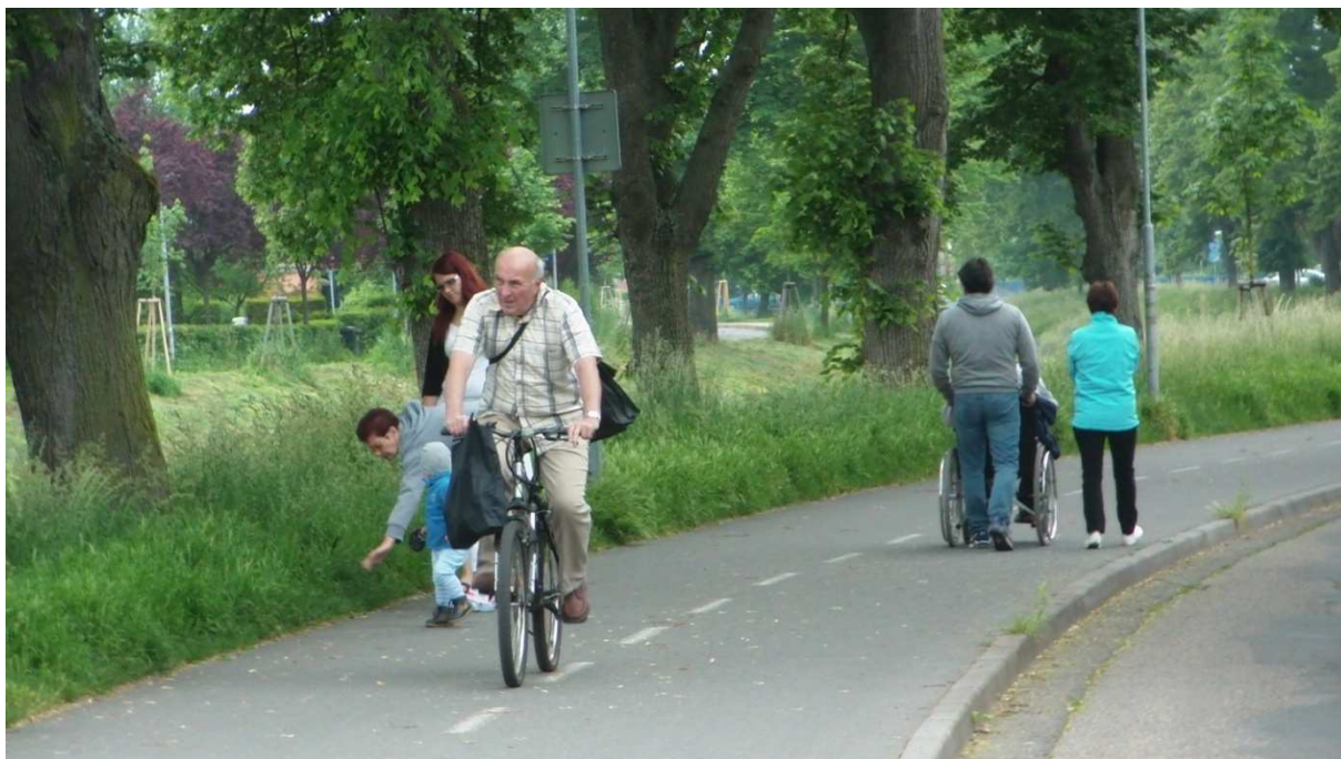
Obrázek 21: Nevyhovující společný provoz chodců a cyklistů podél řeky Dřevnice, vysoké intenzity, neoddělený provoz
