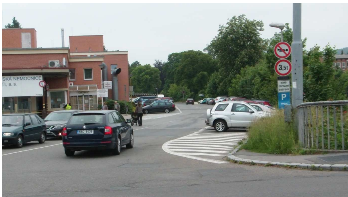
Obrázek 18: Nejasné pěší trasy v prostoru Krajské nemocnice T. Bati, nesnížená obruba, chybějí prvky
